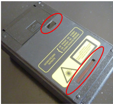
El lado trasero del GC3000 con las dos lentes circularado. Utilice el aire comprimido limpio para limpiar las lentes.
