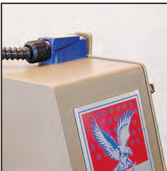
Das ist der Begrenzungsschalter an der Oberseite der 3300RP. Immer wenn die Bandsicherheitsschutztür geöffnet wird, wird der Stromversorgung der Maschine abgeschaltet.
